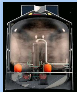
事故后顶部水箱依靠重力向钢制安全壳表面喷淋水，传热和传质分离
