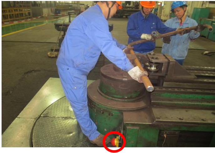
厚壁弯管机增加脚踢式急停开关
