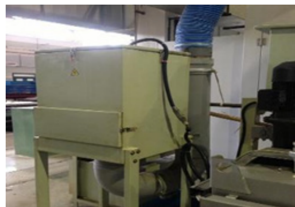
▲ 机床上更新的油雾净化装置
